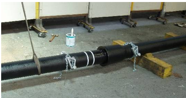
写真6 接合器具のセット
