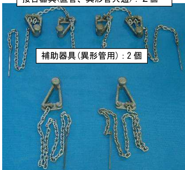
接合器具(直管、異形管共通) : 2 個
