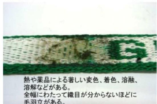
写真1 G X形スリングベルトの廃棄基準例
