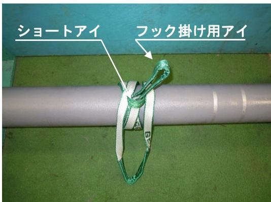
写真2 呼び径100の巻き付け例
