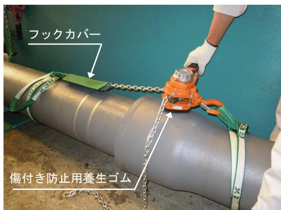
写真2 G X形チェーンレバーホイストのセット状態
