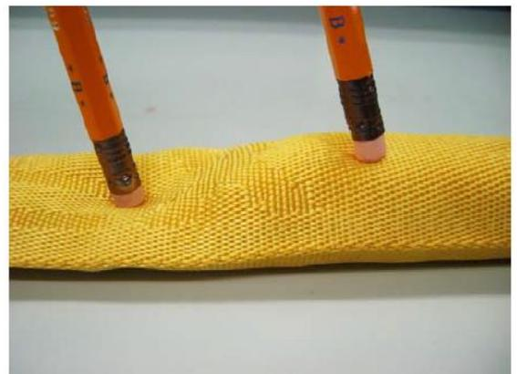
写真1 GX形ラウンドスリングの廃棄基準例
