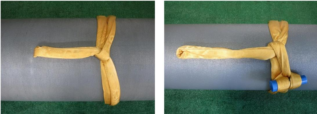
写真2 巻き付け例（左：呼び径 400、右：呼び径 300）
