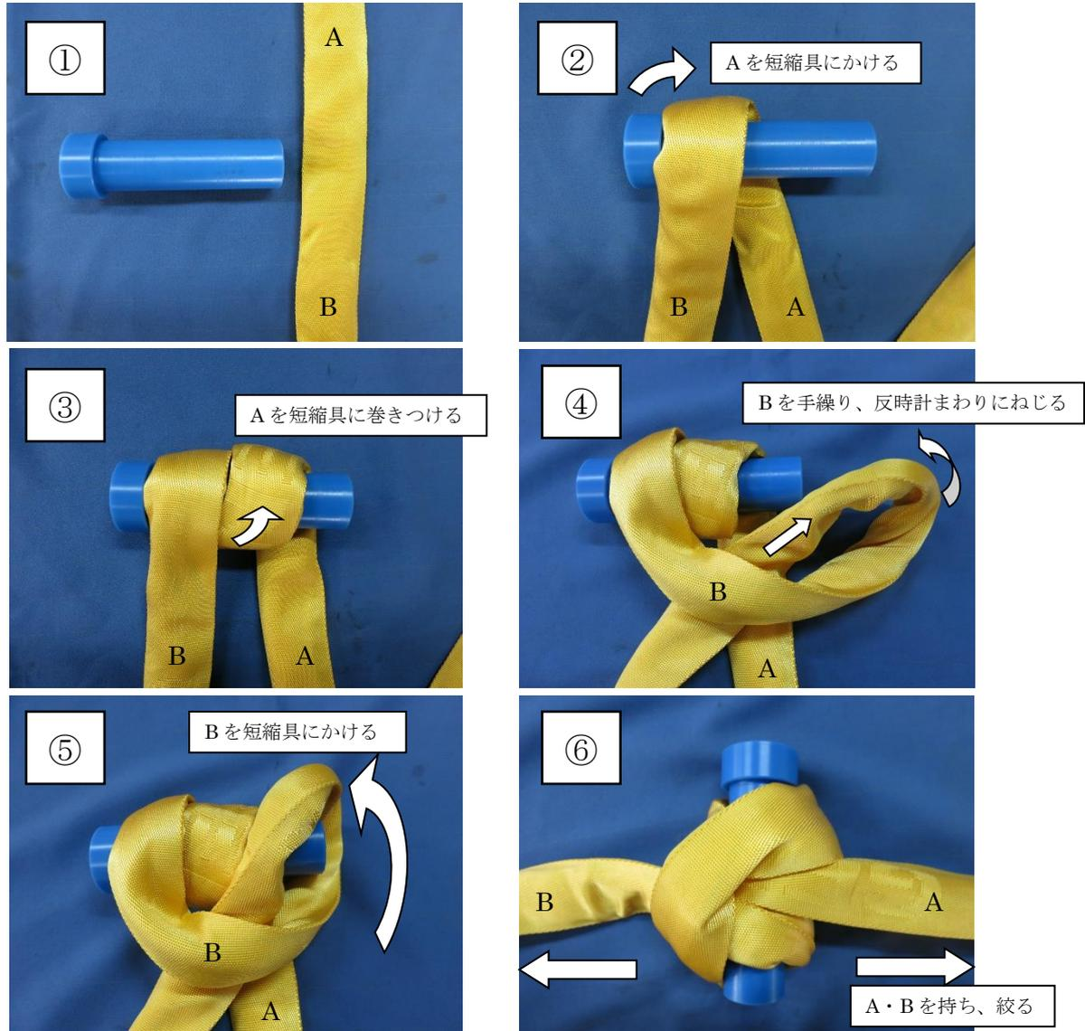
**警告** G X 形ラウンドスリング短縮具に損傷があった場合、使用中に G X 形ラウンドスリングが破断し、重大災害を引き起こす恐れがあります。使用前に傷、変形等の異常がないかの点検をしてください。
