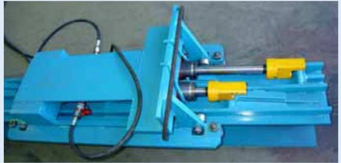
2本の油圧ジャッキが交互に伸縮して自動的に反力点を切り替えて前進することで、従来工法の約1/5の時間での挿入を実現！
