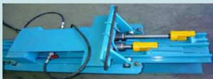
2本の油圧ジャッキが交互に伸縮して自動的に反力点を切り替えて前進することで、従来工法の**約1/5**の時間での挿入を実現!
